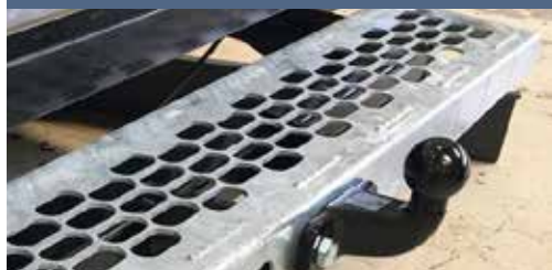
Bilspecifikke modeller lavet i bedste kvalitet. Trin i galvaniseret jern, skridsikkert og meget robust.
